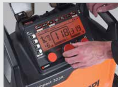
Los paneles de control LCD son amplios y claros, facilitan la configuración y referencia de los parámetros. Las bandejas para piezas brindan almacenamiento y acceso adecuados.
