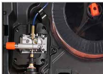
Los modelos Kempact 181/251 incluyen la unidad de alimentación de alambre GT02C, con dos rodillos.
