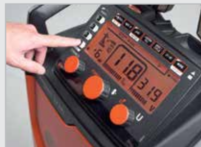
Los modelos Kempact Adaptive (A) incluyen características especiales, como controles para la configuración de la potencia según el espesor de la chapa, selección de los materiales de relleno y canales de memoria.
